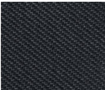
Glasfasergewebe Gewebe aus PVC-ummantelten Glasfasergarnen, Webart Sergé
